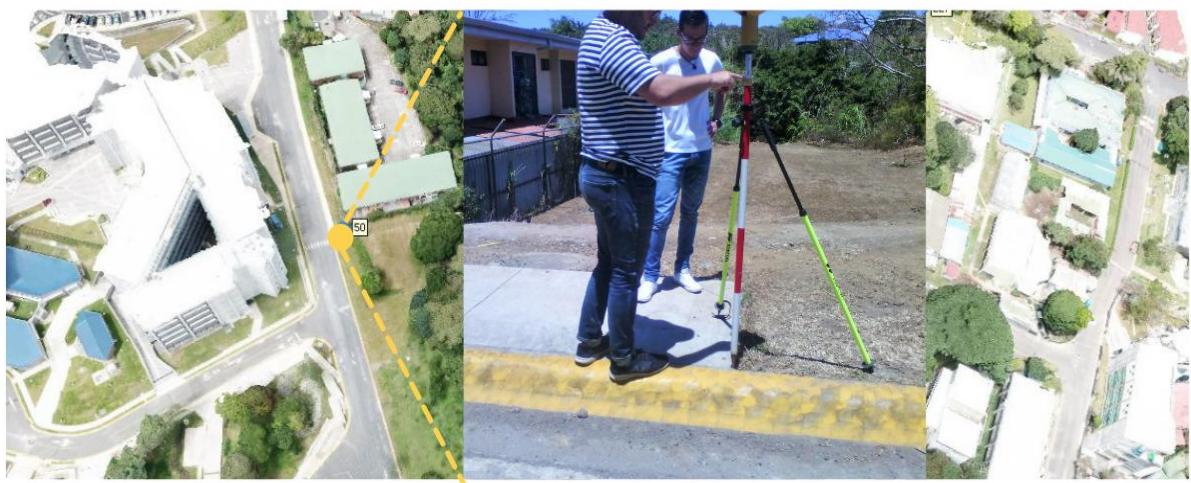
Figura 5. Levantamiento de punto de control terrestre con equipo GNSS en la Finca 2.
