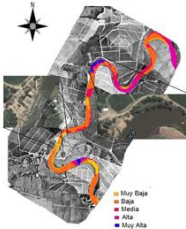
Figura 10. Relación entre los resultados obtenidos de transporte de sedimentos y las visualizaciones actuales de Google Earth.
